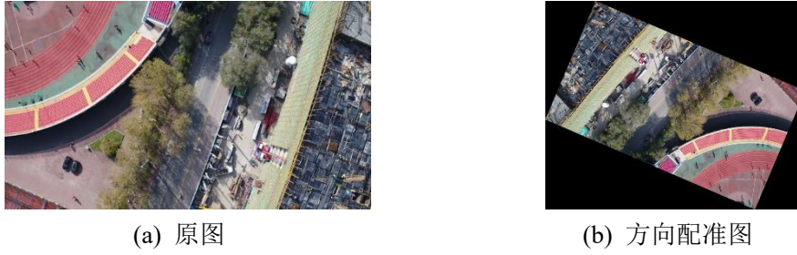
图 7 图像方向配准示例
